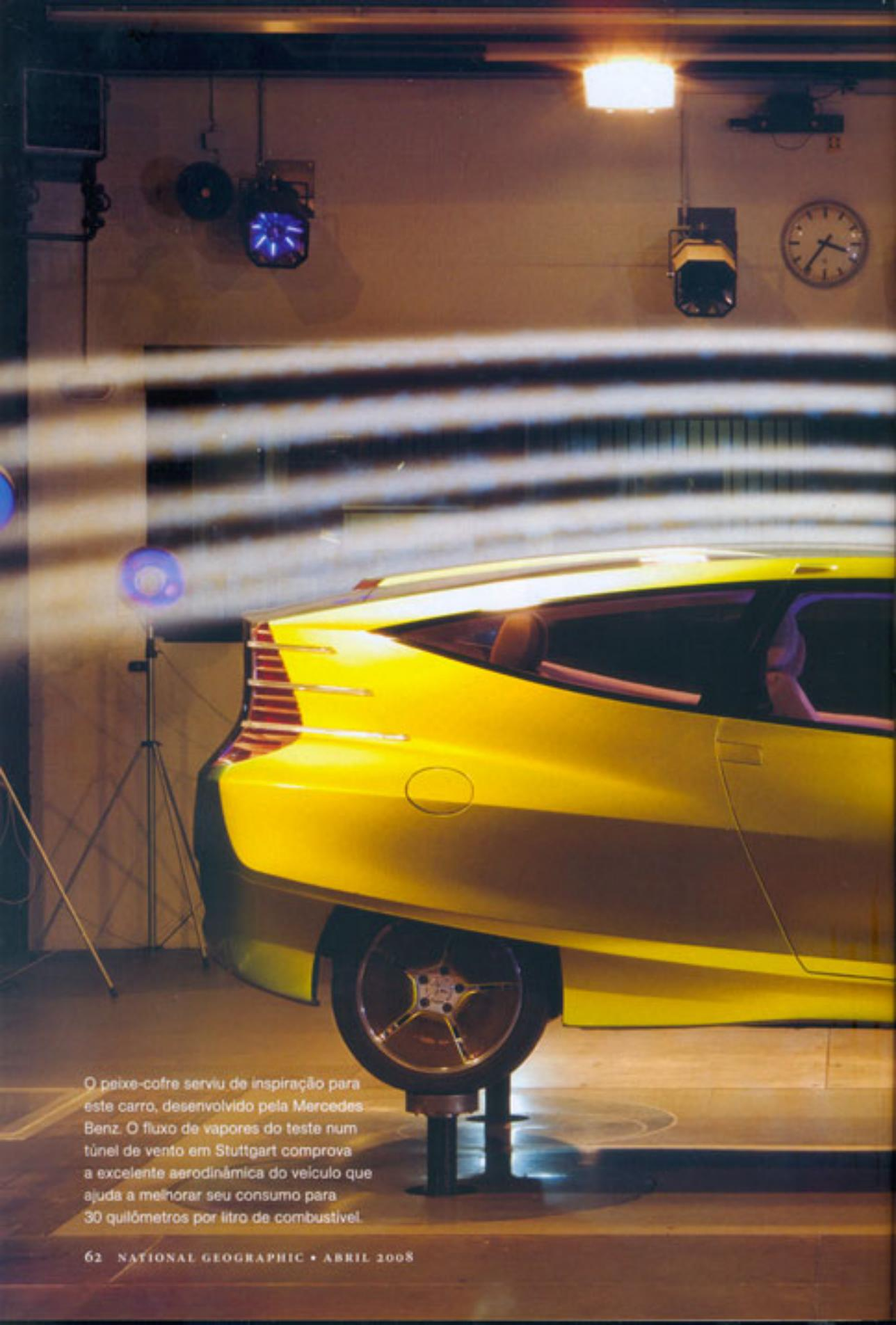
O peixe-cofre serviu de inspiração para este carro, desenvolvido pela Mercedes-Benz. O fluxo de vapores do teste num túnel de vento em Stuttgart comprova a excelente aerodinâmica do veículo que ajuda a melhorar seu consumo para 30 quilômetros por litro de combustível.
